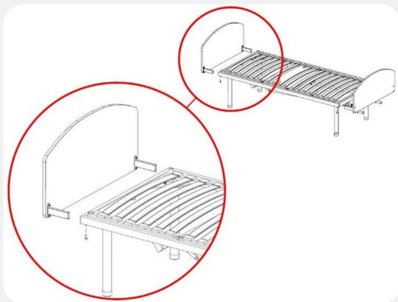
Figura 11 - Montagem de cabeceira/ peseira modelo 10.CM.1089.1.
