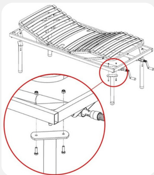
Figura 9 - Montagem pés com tacos
